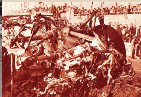
Los restos retorcidos del 300 SLR de Levegh. Faltan la carrocería (de electrón o magnesio, que se quemó) y el motor (que se desprendió y salió despedido).
